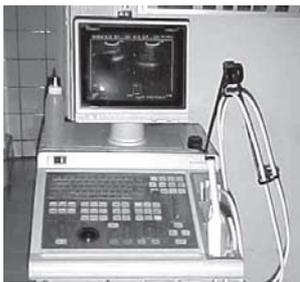
O aparelho da policlínica é um Hitachi modelo EUB 515-A com probes convexas de frequência variável, uma de 7,5Hz (6 a 9Hz), uma de 3,5 Hz (2 a 5Hz) e uma linear de 7 Hz (6,5 a 8,5Hz).
